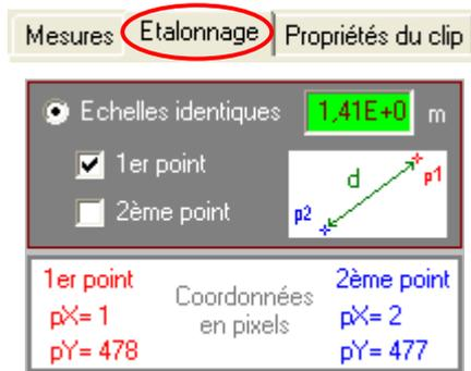
Etalonner les dimensions de l'image en y sélectionnant, à l'aide la souris, deux points. Entrer, à l'aide du clavier, la distance en mètre séparant ces deux points
