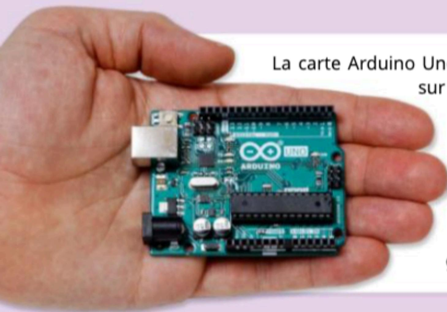
La carte Arduino Uno tient dans la main. Cet ordinateur simplifié est construit sur un circuit intégré unique contenant un **processeur**, une **mémoire** et des **périphériques programmables** d'entrée et de sortie.
